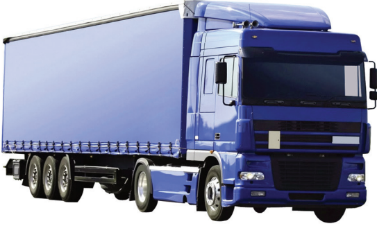
Tekerlek sayısının çok olması kamyonun yaptığı basıncı azaltır.
