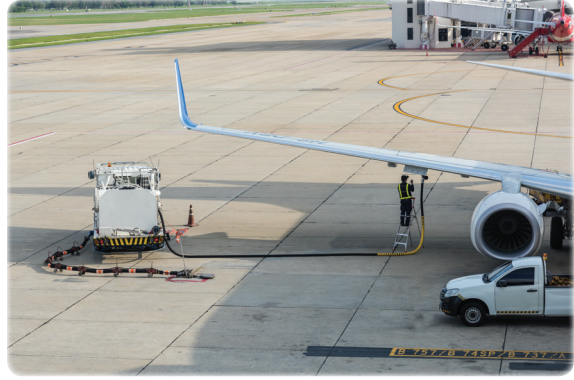
Yakıt doldurulurken topraklanan bir uçak
